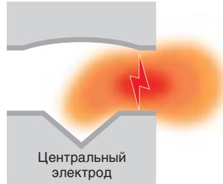
Обычная свеча зажигания
